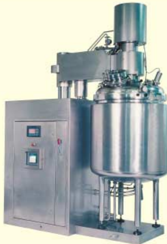
MMD 600 avec bras mélangeur extérieur, arbre de cisaillement et transmission avec l'unique point d'étanchéité contrôlé, peut être totalement stérilisé et validé, utilisé pour des applications ophtalmologiques.
